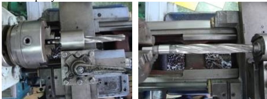
Рисунок 3 – Начальное и конечное положение развёртки-протяжки в процессе обработке цилиндрических отверстий
