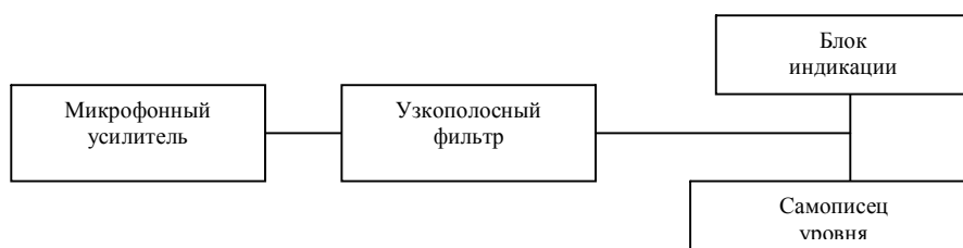
Рисунок 5 – Блок-схема экспериментальной установки для измерения шума.
